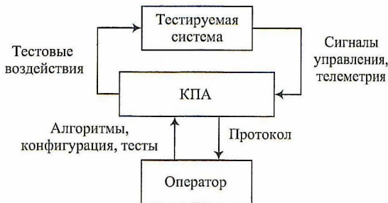
Рис. 1. Обобщенная схема рабочего места для тестирования
